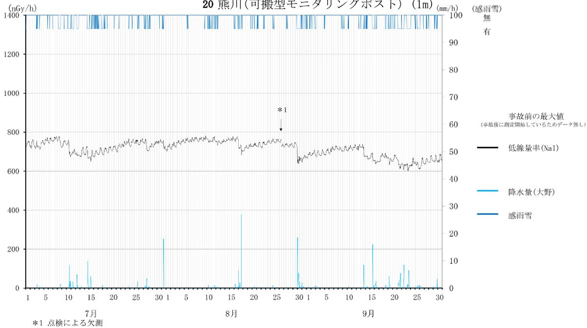
可搬型モニタリングポストには温度制御装置が装備されていないため、線量率が気温の変動による影響を受けて日周期で変動する。
