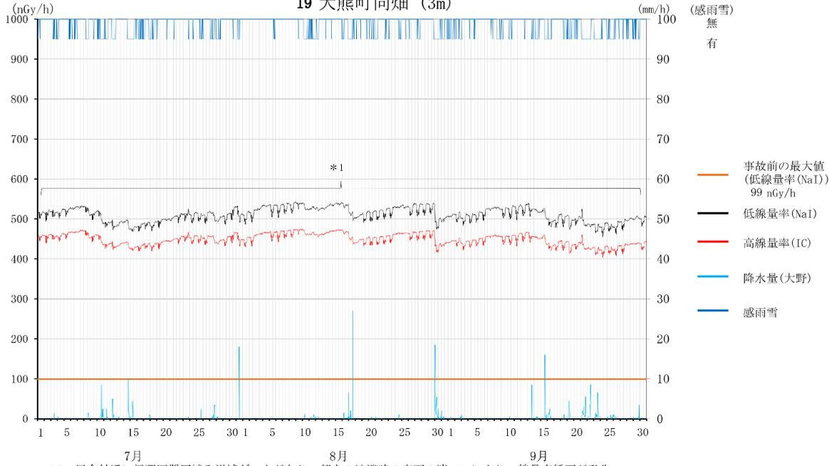
電離箱式検出器 (IC) は高エネルギーの宇宙線についても測定できることから、線量率が低レベルのときの測定値はNaI (TI) シンチレーション式検出器より30nGy/h程度高くなる。また電離箱式検出器は、検出器の形状が球形であり方向特性が良好である一方、NaI (TI) シンチレーション式検出器の形状は21nφ×21nの円柱状であるため、鉛直方向の方向特性を1とした場合、90度方向では1.1程度となる。線量率が数百nGy/h以上の地点では、福島第一原子力発電所の事故により沈着したCs-134及びCs-137による地表面方向 (90度から180度) からの放射線が大部分を占めるため、検出器の方向特性の違いによる影響がより顕著に現れ、電離箱式検出器と比較してNaI (TI) シンチレーション式検出器の測定値が高い傾向となる。
