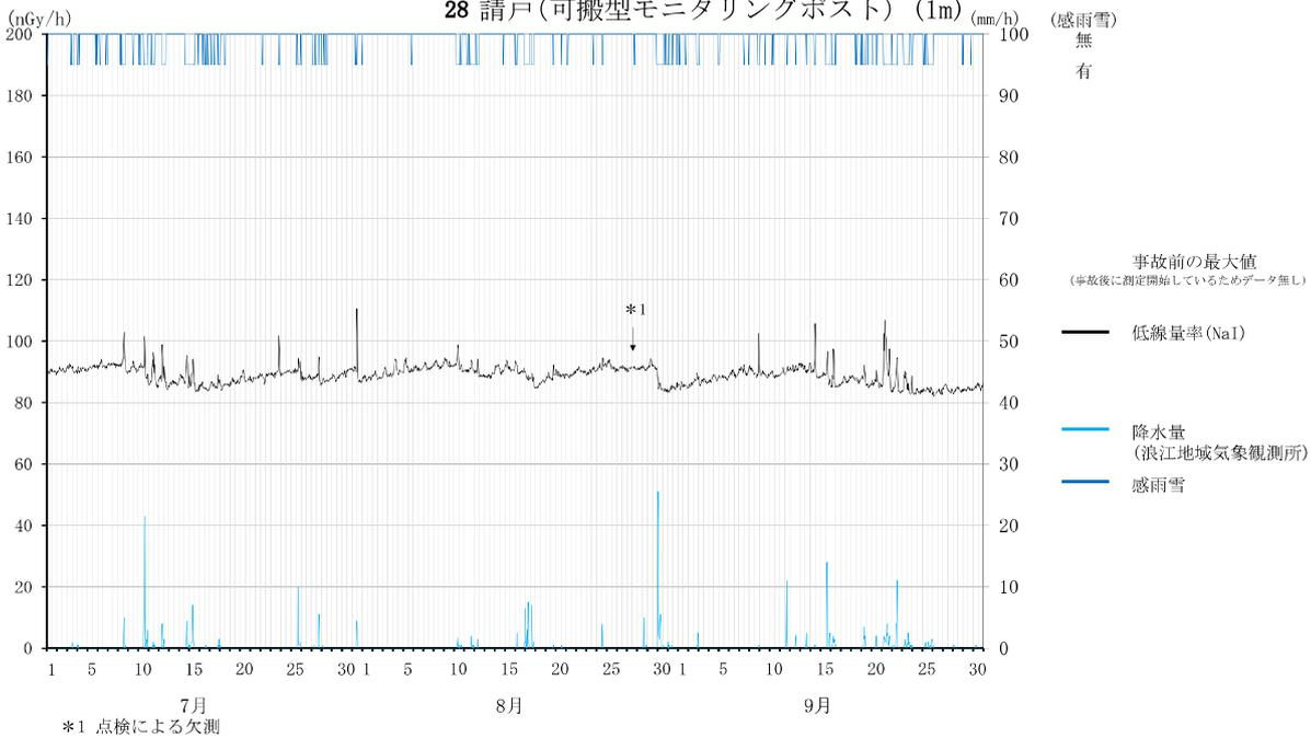
可搬型モニタリングポストには温度制御装置が装備されていないため線量率が気温の変動による影響を受けて日周期で変動する。
