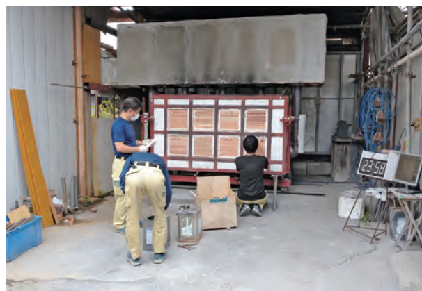
木材と塗料による耐火性能試験（要素試験）の様子
