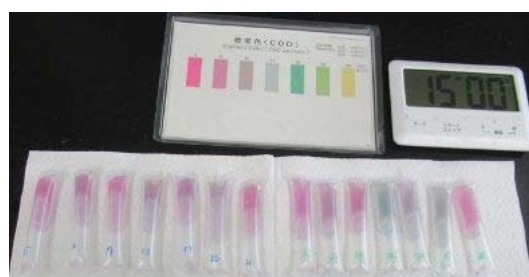
図 1 測定の様子（COD 簡易測定キットを用いた一斉発色・一斉測定）
