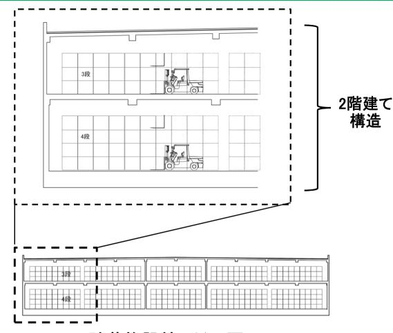
**貯蔵施設棟 断面図** (廃棄物貯蔵施設工事発注時の参考図より作成)
