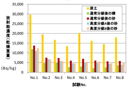
図2. 原土と通常分級後碟・砂.高度分級A.B後砂の放射能濃度
