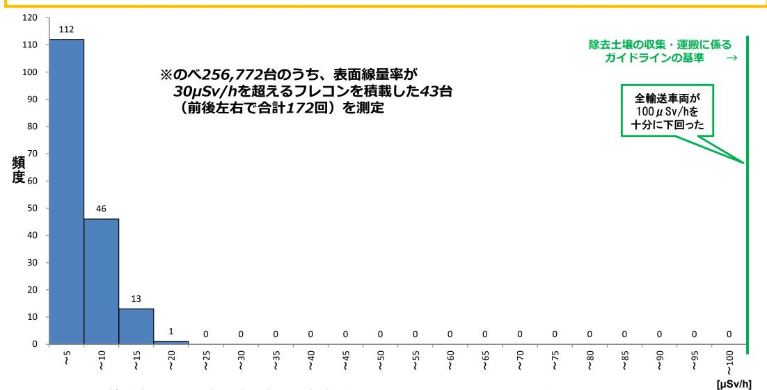
輸送車両周辺の空間線量率の測定結果(2018年4月1日~2019年3月17日) ※バックグラウンドの影響も含む
