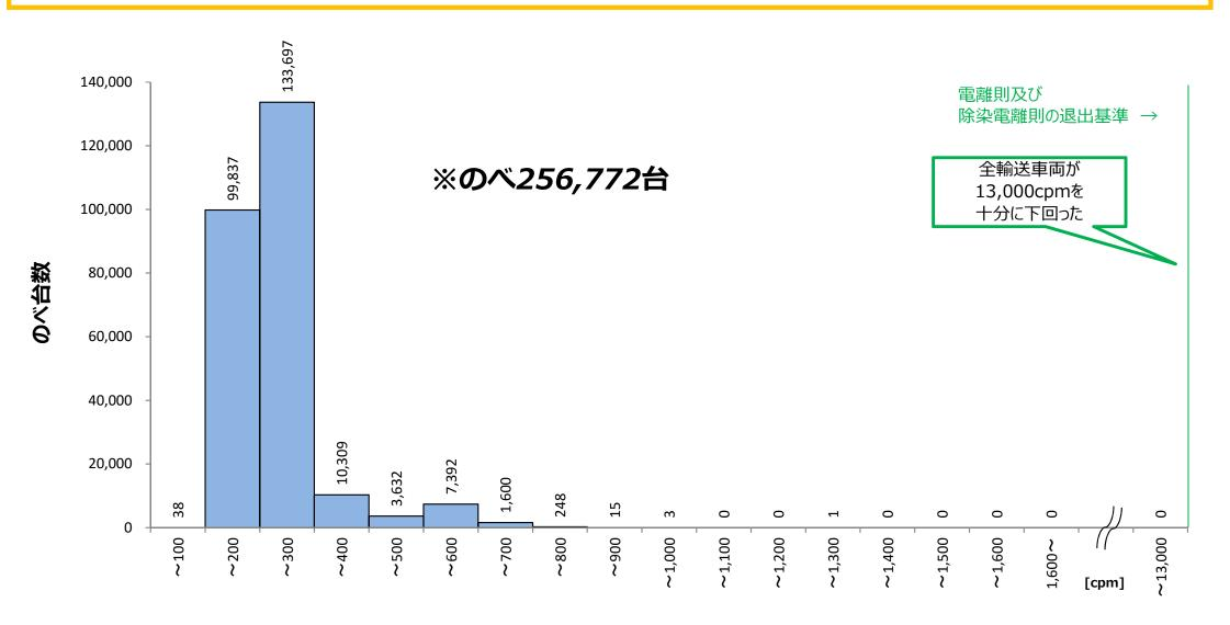
輸送車両のスクリーニング時の最大の表面汚染密度の分布(2018年4月1日~2019年3月17日) ※バックグラウンドの影響も含む
