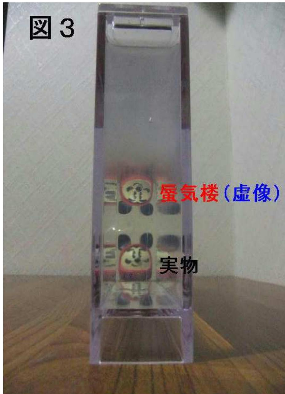
実際の自然界では、冷たい（密度が高い）空気が下層部にあり、暖かい（密度が低い）空気が上層部にあったら、実験 2 の図 3 と同様に光が屈折し、蜃気楼が発生する。
