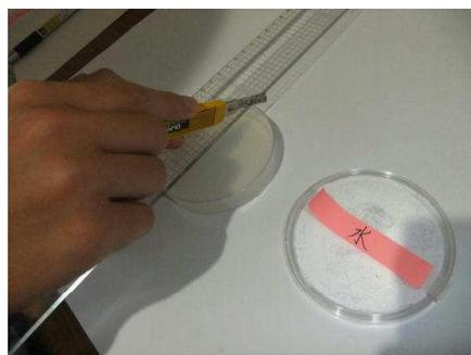
(2) レーザーポインターを使い、寒天レンズの中心に向かって光の入射角を変えて光の進む方向を調べる。
