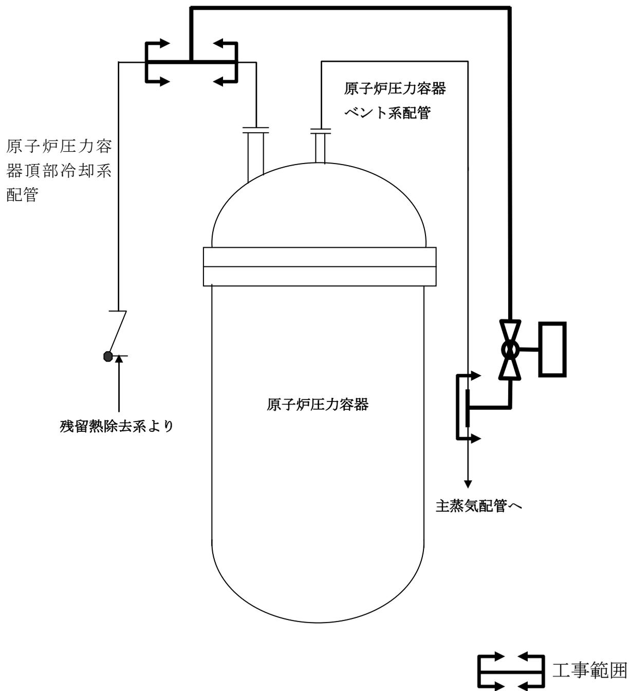
残留熱除去系配管改造工事
