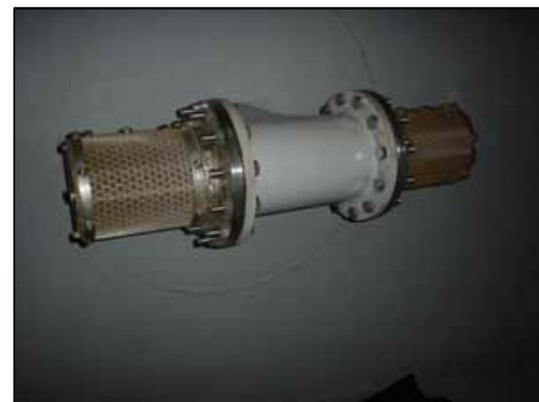
原子炉隔離時冷却系ストレ-ナ
