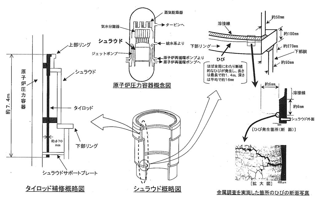
ひび発生状況及びタイロッド補修概略図
